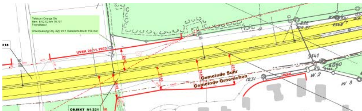
Exemple : AG N01 Suhr - alignements manquants le long des bois, alignements non fermés.
