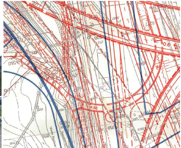
Exemple : ZH N03 Echangeur de Zurich-est (Brunau) – objet à l'intérieur des alignements existants (en bleu), pas de délimitations verticales.
